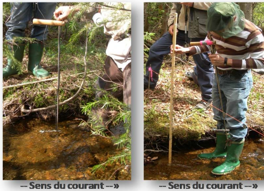
Figure 7 Mesures au micromoulinet (gauche) et de la hauteur d'eau (droite)
